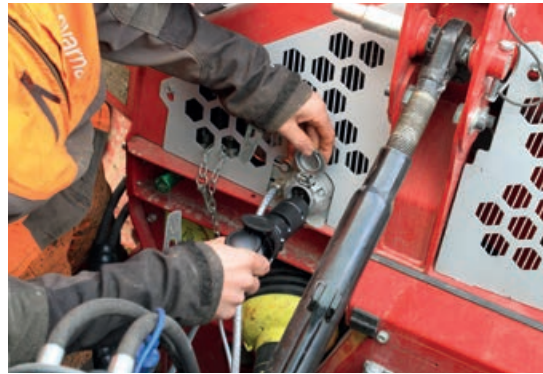
Mit dem neuen Plug-and-Play-Adapter ist keine aufwändige Verkabelung mehr notwendig.
