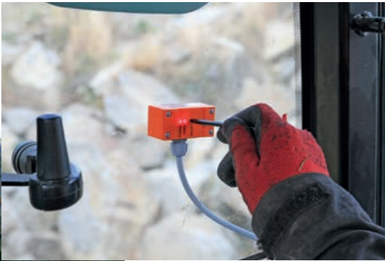
Nullpunkt-Abgleich am Sensormodul mit dem Kalibrierstift.
